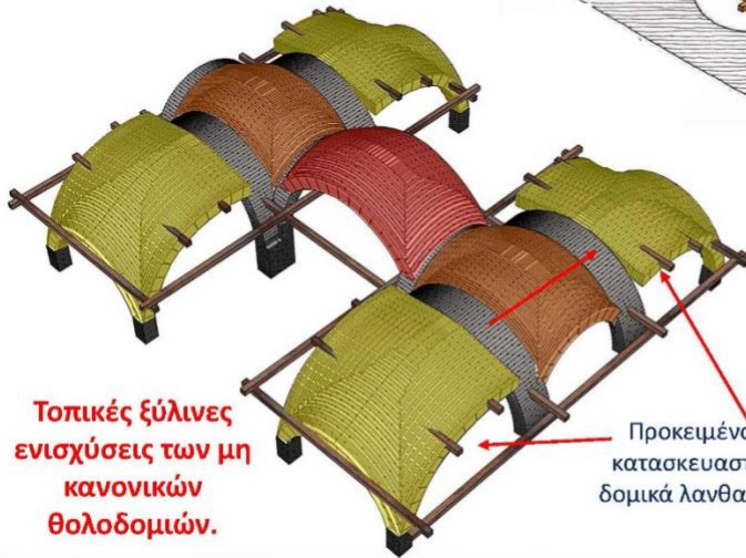
Εικ. 10. Ενίσχυση της Κρυφής, και στις τέσσερις γωνίες, αντικανονικής θολοδομίας με ισχυρές ξύλινες περισφίξεις – ιμαντώσεις.
