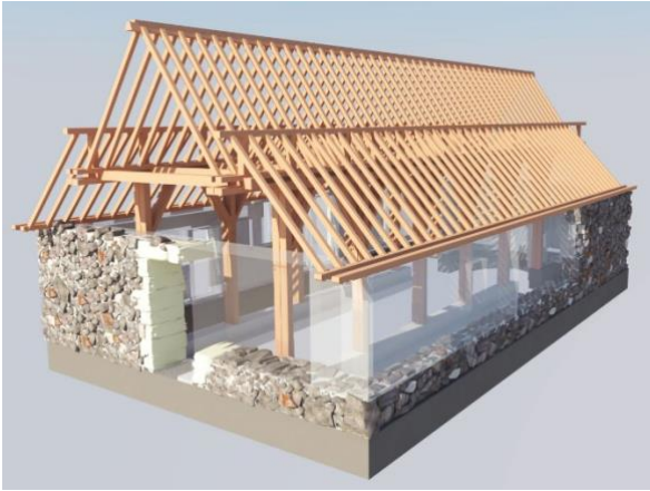
Εικ. 11. Τρισδιάστατη απεικόνιση του δομικού συστήματος της στέγης του Ναού της Παναγίας στο Κούρδαλη. (Πανεπιστήμιο Frederick, 2012, Επιστ. Υπεύθυνος: Μ.Πελεκάνος)
