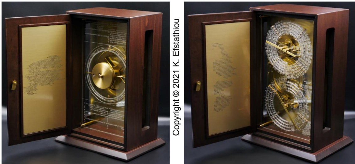
Σχήμα 1. Φυσικό λειτουργικό μοντέλο του Μηχανισμού προσαρμοσμένο στην σημερινή εποχή (αριστερά η εμπρόσθια όψη, δεξιά η οπίσθια όψη)
