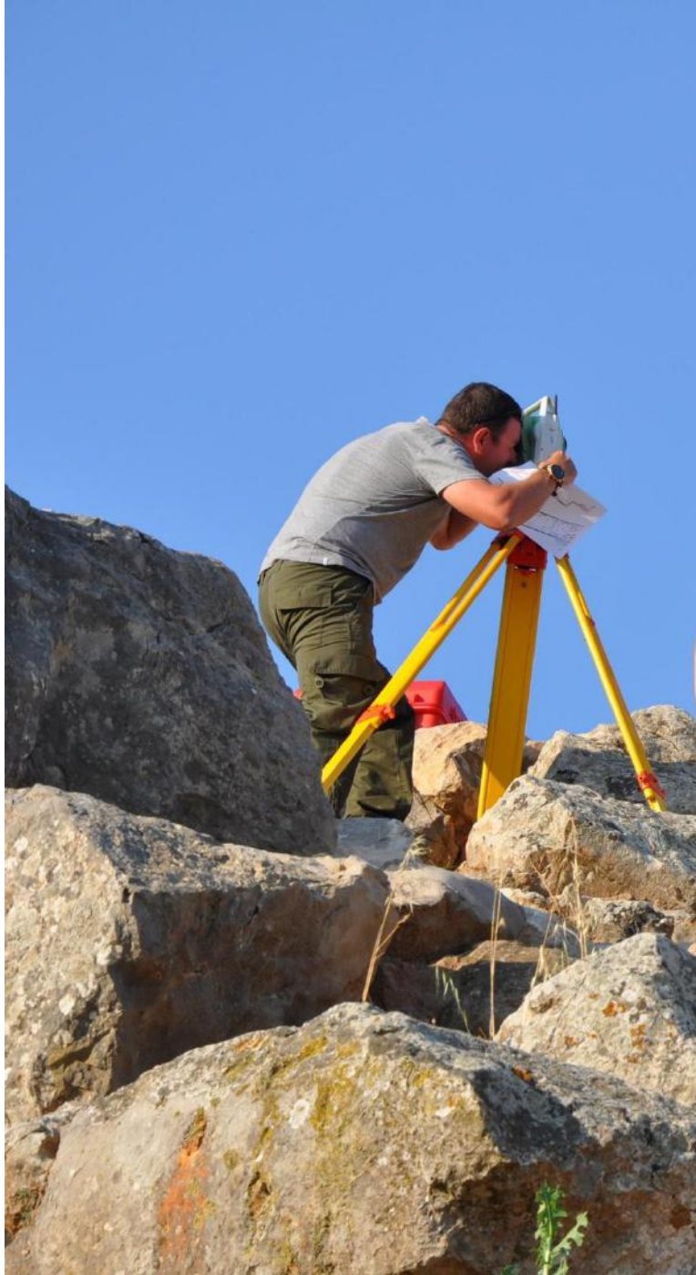
Εικόνα 3 Χρήση ενός γεωδαιτικού σταθμού για τον προσδιορισμό της θέσης των γεωαναφερμένων φωτογραφικών σημείων αναφοράς στο πεδίο κατά τη διάρκεια του θερινού σχολείου πεδίου στην Τίρυνθα με το συνάδελφο Alexis Gorgues το 2015 (Φωτογραφία: A. Brysbaert).
