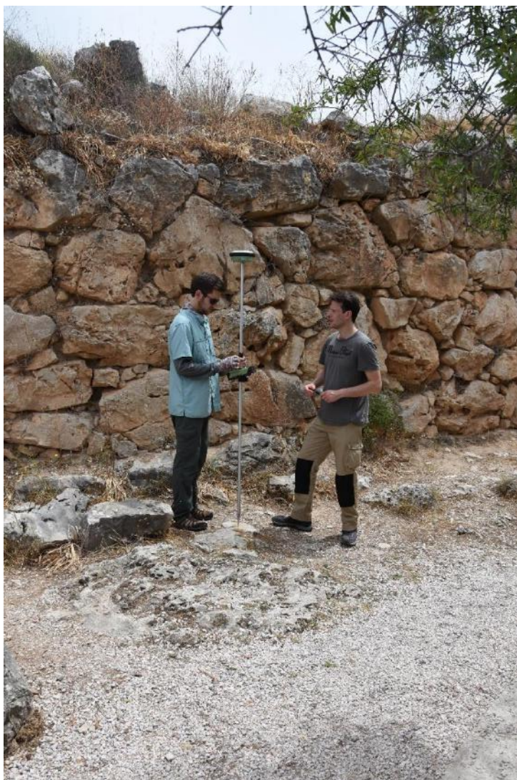
Εικόνα 2 Τα μέλη της ερευνητικής ομάδας του προγράμματος SETinSTONE, Daniel Turner και Yannick Boswinkel, κατά την διάρκεια δορυφορικού προσδιορισμού της θέσης των σημείων αναφοράς στην ακρόπολη των Μυκηνών με τη χρήση ενός διαφορικού GPS Leica το 2017 (Φωτογραφία: A. Brysbaert).
