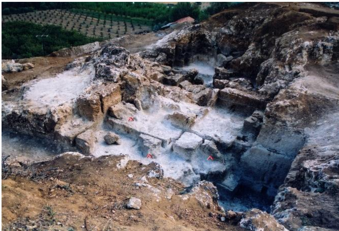
Εικόνα 7. Λατομείο 2. Περιπτώσεις αποτυχημένης απόσπασης λίθων.
