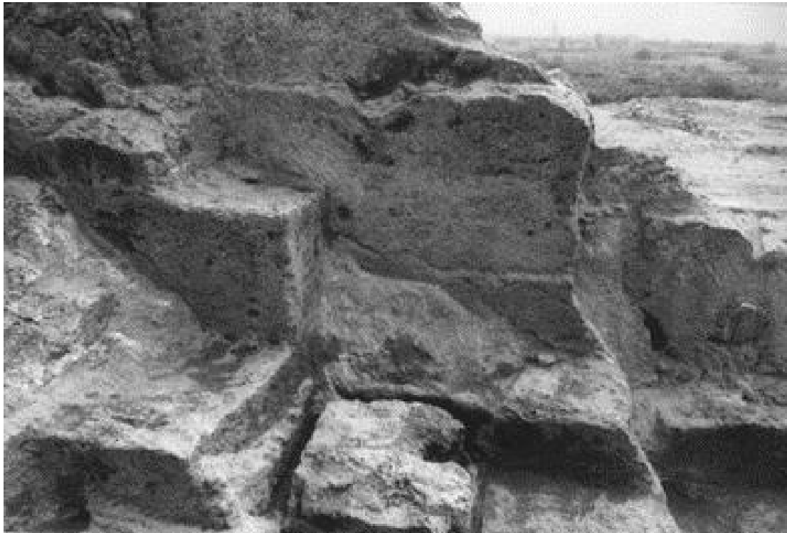
Εικόνα 8. Λατομείο 1. Λίθος που δεν αποσπάστηκε λόγω ελαττώματος και παράδειγμα ανεπιτυχούς απόσπασης.
