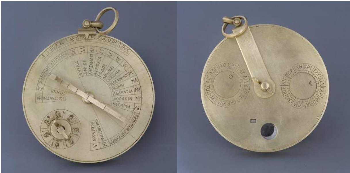
Εικόνες 5α & 5β: Μπροστινή και πίσω πλευρά του φορητού βυζαντινού ηλιακού ρολογιού – Ημερολογίου (Ανακατασκευή και φωτογραφίες από τον M.T.Wright)
