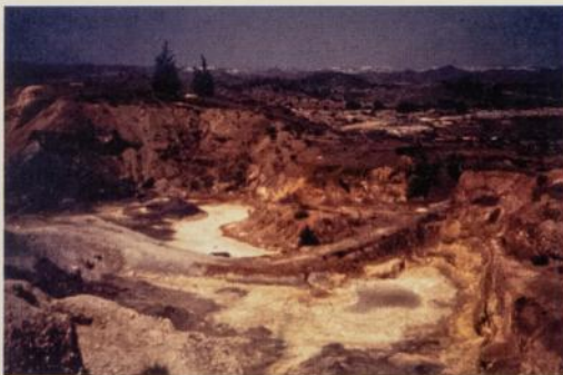
Εικ. 10. Οξειδωμένο κοιτάσμα (gossan), με έντονα κόκκινα και κίτρινα χρώματα. Σε μικρό βάθος βρίσκεται το ανοξειδωτο κοιτάσμα (ανοικτά χρώματα) στο μεταλλείο Βόρειος Μαθιάτης.
