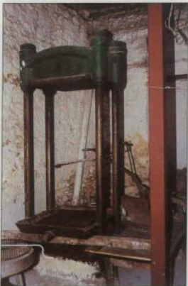
4. Θουρία, Ελαιοτριβείο Αποστολάκη. Το υδρικό πιεστήριο του οίκου Victor Coq.
