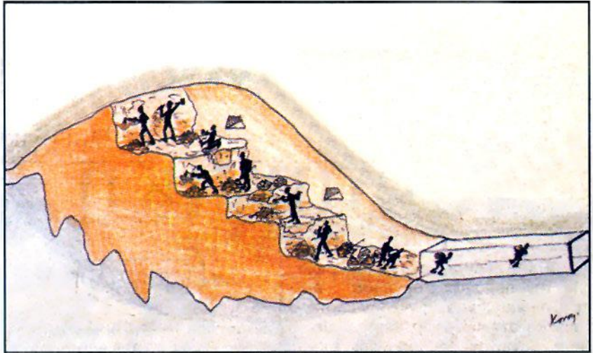
Τρόπος εξόρυξης μεταλλεύματος με τη μέθοδο των βαθμίδων (σχέδιο Κ. Κονοφάγου).
