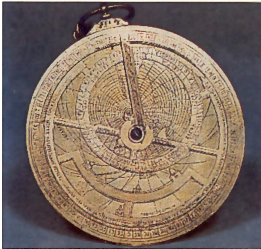
Βυζαντινός επίπεδος αστρολάβος διαμέτρου 14 εκ. από ορείχαλκο, του 1026 μ.Χ., ο οποίος συνεχίζει την αρχαία παράδοση.
