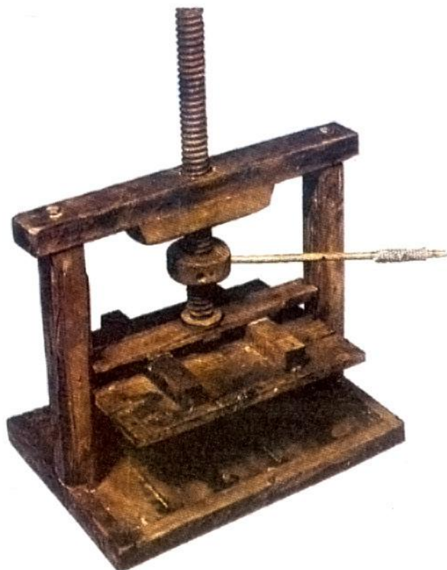
Πάνω: πρέσα λαδιού Ηρωνος. Δεξιά: αναρροφητική - καταθληπτική αντλία Κτησιβίου (κατασκευαστής: Δ. Κριάρης).
