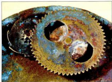
4. Το Βυζαντινό Ηλιακό Ρολόι Ημερολόγιο: τα δύο κινητά τμήματα, συναρμολογημένα στην πίσω όψη του κυρίως δίσκου, δείχνουν με το επτά δόντια, που στρέφεται μια φορά την εβδομάδα, ενώ τον δίσκο της Σελήνης με το 59 δόντια.
